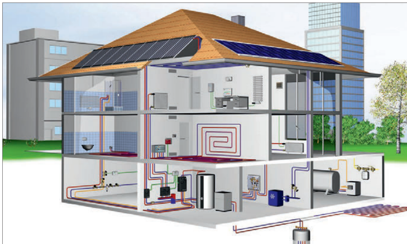
Пример: устройство гелиосистем в коттедже
